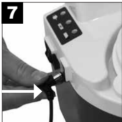
Se usar energia CA ou CC, conecte o conector pequeno à entrada de energia de CC, na lateral da unidade.
