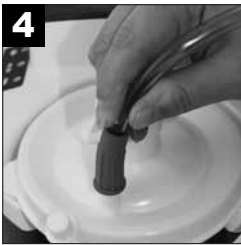
Unir el tubo de 6' del paciente a la tapa del contenedor en el conector de salida etiquetado <Patient> (<Paciente>).
