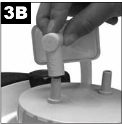
Conexión de depósito reutilizable: Cuando lo instale, asegúrese de que el lado transparente del filtro bacteriano mire hacia el codo y la botella. No invierta la dirección del filtro. A continuación, conecte el filtro bacteriano a la conexión del codo de 90° y conecte el codo a la parte superior de la tapa del depósito donde dice <Vacuum>.
