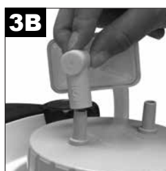
Verbinding van herbruikbare opvangpot: Controleer of de doorzichtige kant van het bacteriefilter tijdens de installatie naar de elleboog en fles is gericht. Keer de richting van het filter niet om. Het bacteriefilter moet dan op de elleboogverbinding van 90° worden aangesloten en de elleboog moet aan de bovenkant van het deksel van de houder worden aangesloten, waar <Vacuum> staat vermeld.
