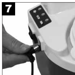
Wanneer u gebruikmaakt van wissel- of gelijkstroom, steekt u de kleine connector in de gelijkstroomingang aan de zijkant van het apparaat.
