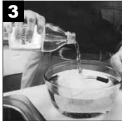
A continuación, sumérjalo durante 60 minutos en una solución formada por una parte de vinagre (>=5% concentración de ácido acético) y tres partes de agua (55 C-65 C). Enjuáguelo con agua limpia y tibia y déjelo secar al aire.
