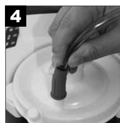
Sluit de patiëntslang van 1,8 m aan op de aansluiting op het deksel van de pot met de tekst <Patient>.
