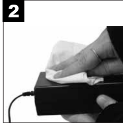
Limpie los cables y la carcasa del adaptador CA-CC con un paño seco.
