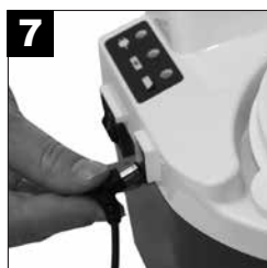
7 Si vous utilisez l'alimentation CA ou CC, connectez le petit connecteur dans l'entrée d'alimentation CC sur le côté de l'appareil.
