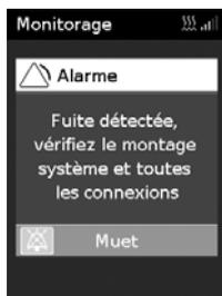
Quand une alarme est activée, le témoin d'alarme jaune clignote, l'alarme retentit et un message apparaît à l'écran.
