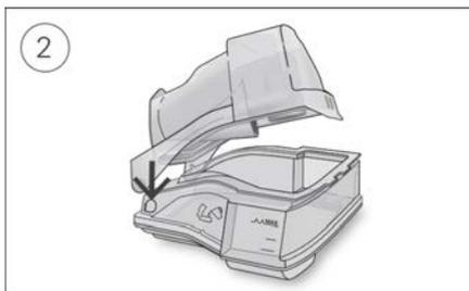
1. Insérez un côté du couvercle dans le trou de pivot de la base.
