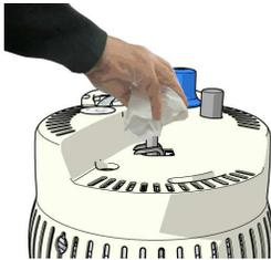
Éliminer toute trace d'humidité sur la borne de remplissage de la FREELOX RESERVE et du portable en utilisant un **chiffon en coton propre et non pelucheux** (l'humidité provoque la formation de givre sur la borne et peut entraîner une fuite d'oxygène).
