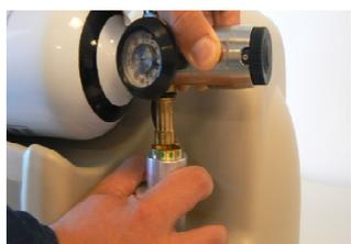
12. Pour retirer la bouteille du **HomeFill II**, il suffit d'**abaisser la bague métallique** du connecteur de remplissage tout en maintenant la tête de la bouteille. Puis enlever la bouteille.
