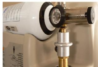
6. Enclencher sans efforts la bouteille dans le connecteur de remplissage du compresseur **HomeFill II**.
