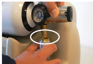
5. Abaisser la bague métallique avant d'enclencher la bouteille. Les points verts du connecteur apparaissent.
