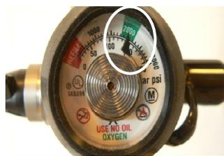
9. Durée de remplissage, **environ 2H** sur une bouteille de 1,7L. La bouteille possède une jauge qui vous permet de vérifier son niveau de remplissage. La bouteille est pleine à 2000 Psi à la fin de la zone verte.
