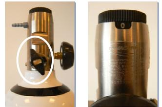
4. Pour remplir la bouteille en débit continu, mettre en position 0 et ouvrir le robinet ON/OFF. **Le laisser ouvert sur ON.**
